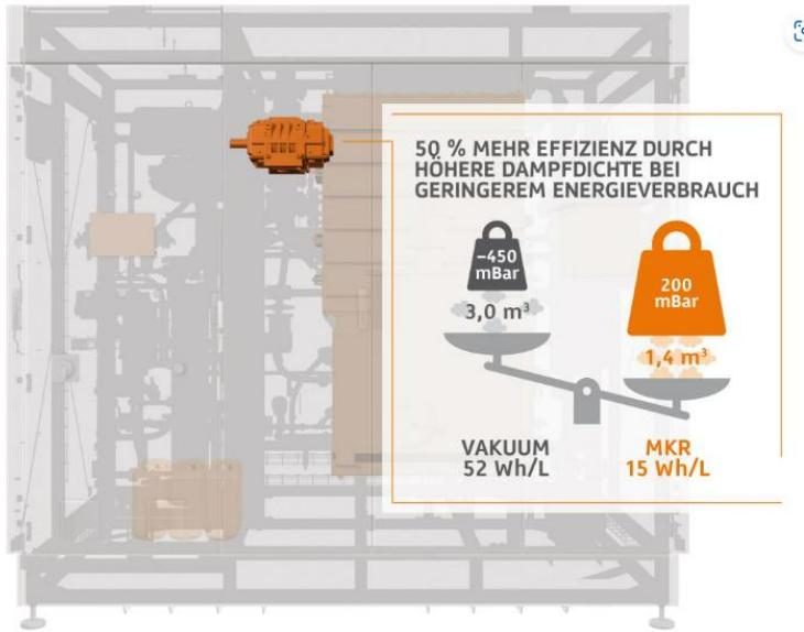
Der Verdichter verringert die mechanischen Arbeit durch höchste Dampfdichte (bis zu 50 % effizienter als Vakuumverdampfer). Durch eine 3-stufige Rekuperation wird ein geringer Energieverlust erreicht, was niedrige Energiekosten bedeutet.
